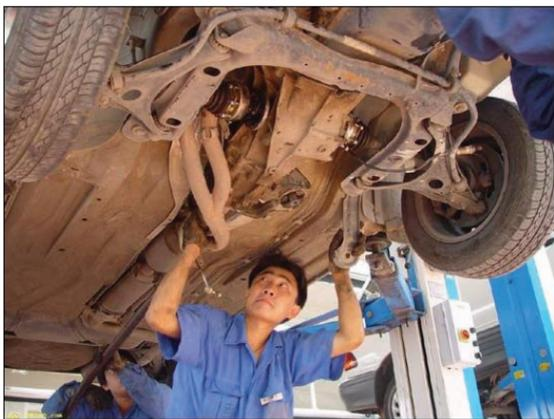
蝕造成的剎車管斷裂、轉向油管斷裂、燃油管斷裂對在高速公路上行駛的車輛就是車毀人亡的事故隱患。我們不能把看不到當不存在。在多年的維修實踐中我們經常處理各種車爛油管、爛車體、爛排氣管等事件, 甚至有的車承載發動機的橫梁爛掉使發動機拖地的案例。
